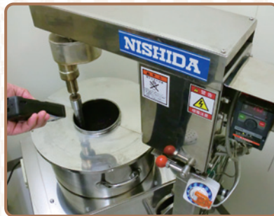
▲この小さな機械で焙煎します。1回に2kgです。
